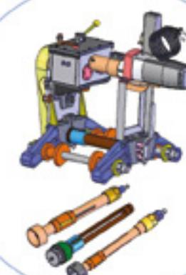
Приспособление для обработки отверстий муфт турбин ГМ.431 и ГМ.436
