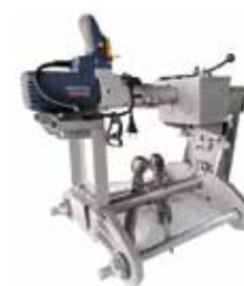
Пристрій для райбування муфт турбін ГМ.437
