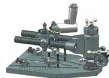
Пристрій Т01.32 для фрезерування запічників
