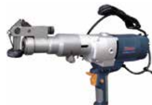
Пристрій Т01.114 для відтягування вусиків ущільнень
