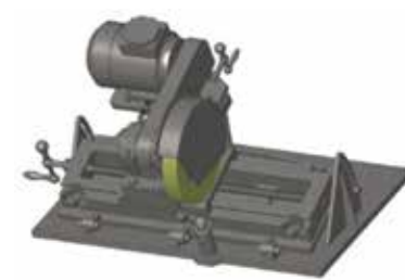
Пристрій для шліфування шийок роторів Т01.86
